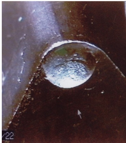
Figura N°2- Tipica usura per craterizzazione su un creatore
