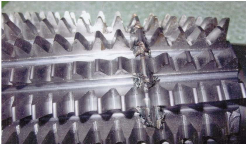
Figura N°3- Intasamento dei trucioli nei solchi mal dimensionati
